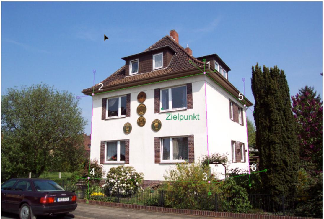
Mit dem Hilfsmittel **Strecke** werden zunächst die sichtbare Kanten nachgezeichnet und die mehr oder weniger unsichtbaren konstruiert. Erzeugen Sie dazu ein neues Objekt und machen es aktiv.
