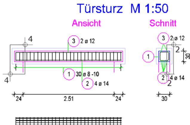
Ändern Sie nun den Verlegeabstand im mittleren Bereich des Balkens. Hierzu verwenden Sie die Direkte Objektmodifikation. Im Anschluss daran ändern Sie noch den Durchmesser der unteren Längsbewehrung über die Eigenschaftspalette.
