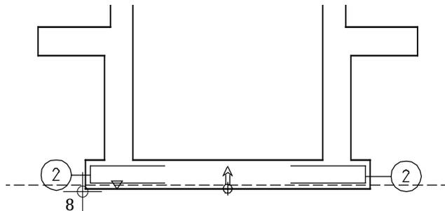
Die gestrichelte Linie zeigt die aktuelle Lagertiefe der Bewehrung unter Berücksichtigung der Betondeckung. Das Höhenkotsymbol gibt die Lagertiefe des eingegebenen Definitionspunktes wieder. Der Pfeil zeigt die Richtung der positiven Eisenschenkel und die Verlegerichtung des Stabes.
