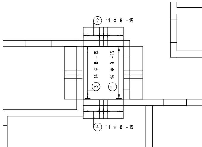
Für die Auswechslung der Deckenaussparung fehlt nun noch die Längsbewehrung.
