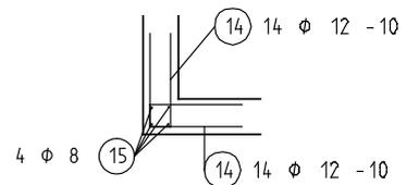
Mit der Ansichtsverlegung können Sie den eingegebenen Eisen Verlegestückzahlen zuordnen, ohne dass Sie die Eisen über einen bestimmten Bereich verlegen müssen. Die Bewehrung wird nur in einer Ansicht dargestellt.
