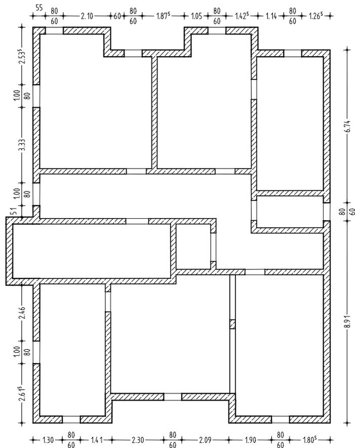
8 Zeichnen Sie jetzt gemäß Abbildung die Fenster ein. Achten Sie bei der linken Außenwand auf die geänderten Parametereinstellungen.
