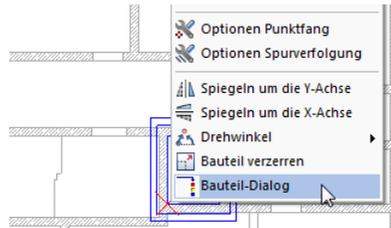
Das Eingabedialogfeld des Bauteils wird zur Modifikation der Geometriedaten eingeblendet.
