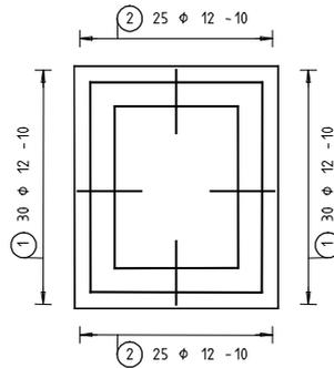
Grundriss Schachtwände d=30cm
