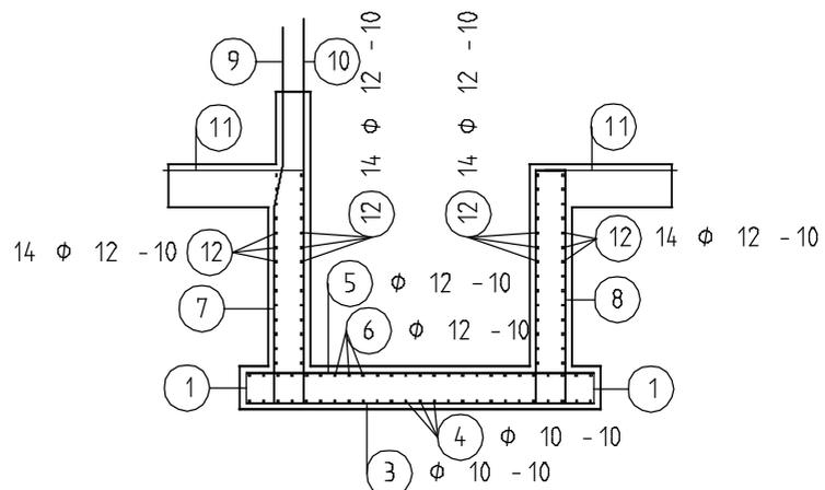
Die Aufzugsunterfahrt ist jetzt, mit Ausnahme der horizontalen Eckverbügelung, die als Regeldetail dargestellt wird, fertig bewehrt. Zum Abschluss legen Sie den endgültigen Schnittbereich der Schachtwände fest.
