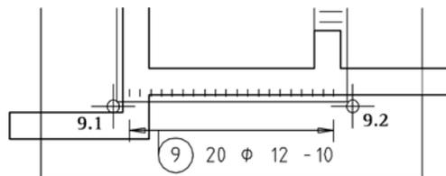
**Tipp:** Kontrollieren Sie nach der Festlegung des Verlegebereichs in der Isometrie, ob die Lage des gekröpften Eisens richtig ist. Drehen Sie das Eisen ggf. indem Sie als Drehwinkel **Lot+180°** wählen.
