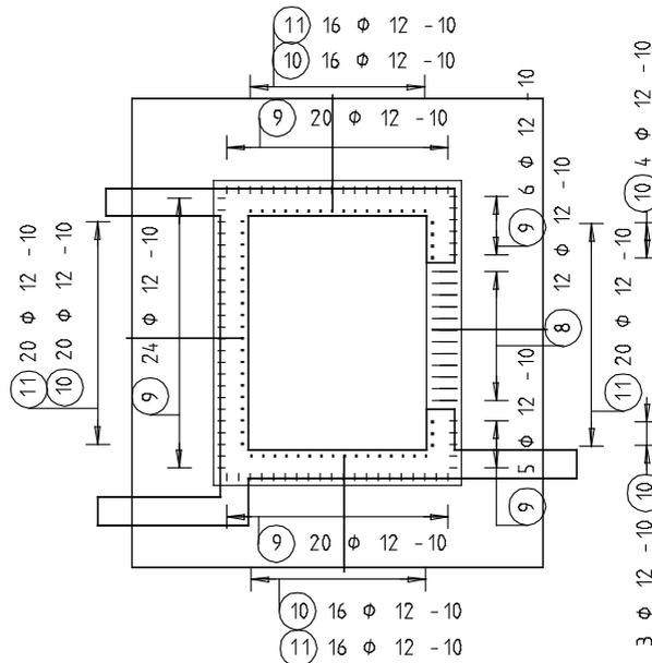
Die Verlegung von Position 9 und 10 ist auch im Grundriss der Bodenplatte vorhanden. Da die Darstellung der Wandeisen hier nicht gewünscht ist, blenden Sie diese aus.
