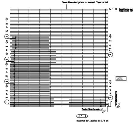
Als Grundlage für die Bearbeitung verwenden Sie den nachfolgenden Deckengrundriss, der im "Finite Elemente Handbuch" von Allplan in ausführlicher Weise erzeugt und mit der automatischen Übernahme von FEM-Ergebnissen bewehrt wird. Von dort stammen auch die FEM-Ergebnisse für die Festlegung der Bewehrung in dieser Übung.
