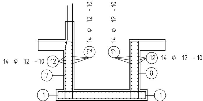
13 Verfahren Sie nun mit der horizontalen Bewehrung der Querseite analog wie zuvor beschrieben. Aktivieren Sie zur Eingabe der Biegeform in den Eingabeoptionen die **Expansion an Schalkanten**, legen Sie im Schnitt B-B eine neue Verlegegerade im Bereich der Schachtwand von oben nach unten fest und schalten Sie abschließend wiederum im Grundriss der Bodenplatte die Querbewehrung unsichtbar.
