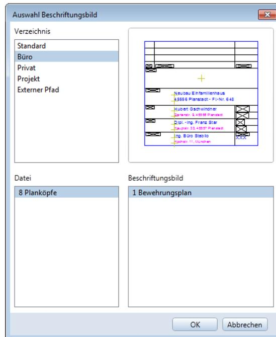
Der Plankopf wird automatisch mit den eingestellten Abständen in der unteren rechten Ecke abgesetzt.
