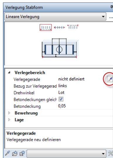
Die Übernahme einer vorhandenen Verlegegeraden erleichtert und beschleunigt die Verlegung von Zwischenbügeln oder von Stabsegmenten nach der Polygonzerlegung langer Biegeformen. Hierbei wird der Start- und Endpunkt der angeklickten Verlegung übernommen. Um auch die übrigen Verlegeattribute auf die neue Verlegung zu
