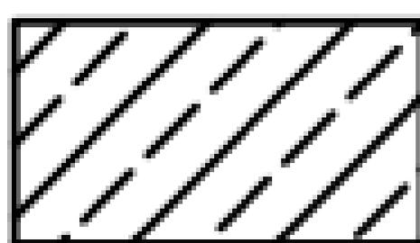
Stahlbeton C20/25 für Wände
