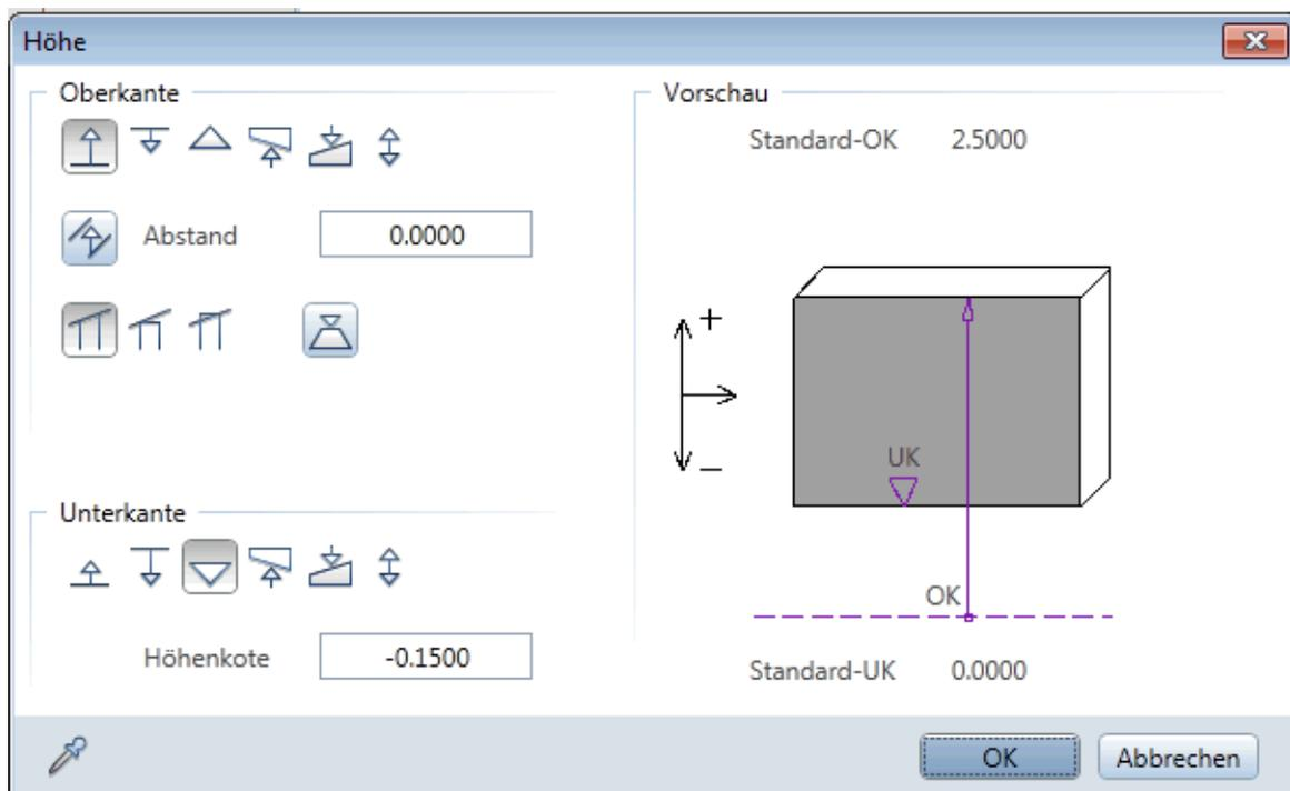
D.h. die Oberkante der Wand soll entlang dem Treppenverlauf folgen und wird also an die untere Ebene des Ebenenpaares gebunden (also im Bereich der "Treppenebenen" an die Unterkante der Stufen). Die Wandunterkante soll auf konstanter Höhe bleiben und wird deshalb, ohne Ebenenbezug, als absolute Kote definiert.
