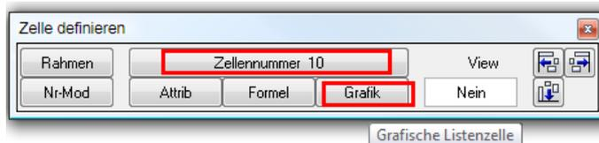
Jede Zelle erhält eine Nummer, die von entscheidender Bedeutung ist. Achten Sie immer darauf, dass alle Zellen in einem Legendensbereich durchlaufend nummeriert werden. Die Reihenfolge spielt keine Rolle, die Zahlenreihe muss lediglich geschlossen sein. Überprüfen Sie gegebenenfalls die Zellennummerierung mit **Nr-Mod**, Zellennummer modifizieren.
