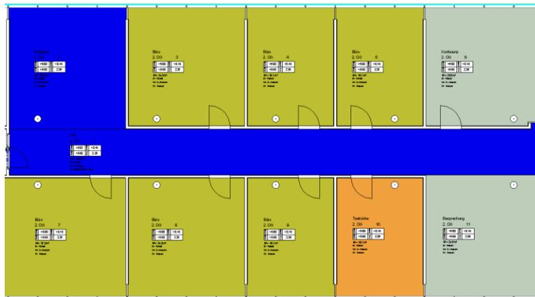
Räume können im Register Ausbau mit sämtlichen Attributen und Schichten für Boden,- Decke,- und Wandflächen versehen werden. Beim Bodenaufbau wird die Summe der einzelnen Schichten für die Angabe der Bodenhöhen im Raumstempel verwendet.
