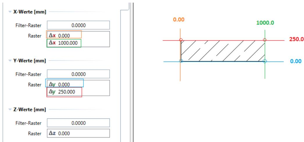
Leider sind in Allplan alle Bauteile polygonal, also auch runde Stützen. Diese verursachen leider Punkte, die nicht in "Raster" passen. Aber dafür kann man ja bestimmte Bauteile rausnehmen bei "Filter". Das Filter-Raster unterdrückt alle Werte, die auf diesem Wert "basieren", d.h. bei 1.0 (mm) werden alle Abstände, die genau ein Millimeter oder ein vielfaches davon sind, nicht angezeigt.
