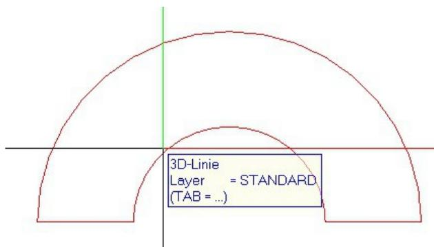
Ich bleibe in den Funktionen Zusätzliche Module und zeichne mir eine 3D Linie in z – Richtung. Diese 3D Linie zeichne ich in einer Ansicht oder am Besten in der Isometrie.
