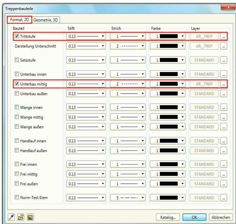
Im Bereich **Bauteil** bestimmen Sie durch Aktivieren der Kontrollkästchen, welche Treppenbauteile im Grundriss und in den Projektionen dargestellt werden. Diese Kontrollkästchen finden Sie auch in der Registerkarte Geometrie, 3D. In unserem Beispiel aktivieren Sie die **Trittstufe** und den **Unterbau mittig** und stellen dessen Parameter wie Stift, Strichart und Farbe ein. Sie können alternativ jedem Bauteil einen Layer zuordnen und dessen Formateigenschaften übernehmen.
