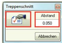
Mit dieser Funktion kann für Treppen die architekturenspezifische Grundriss-Schnittdarstellung erzeugt werden. Bestimmen Sie über Eigenschaften die Darstellung der Strichart Unten und Oben oder ganz ausgeblendet werden soll.
