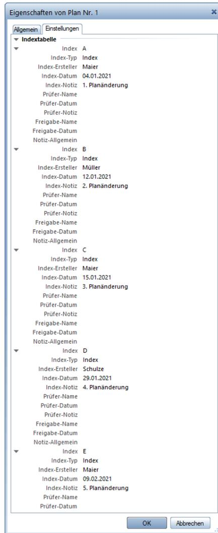
**Hinweis:** Wenn Sie bei dem Attribut **Index-Notiz** ein kürzeres Format gewählt haben, aber bei der Eingabe die komplette Länge ausnutzen, so wird der Rest, der über das definierte Format hinausgeht, im Plankopf abgeschnitten.
