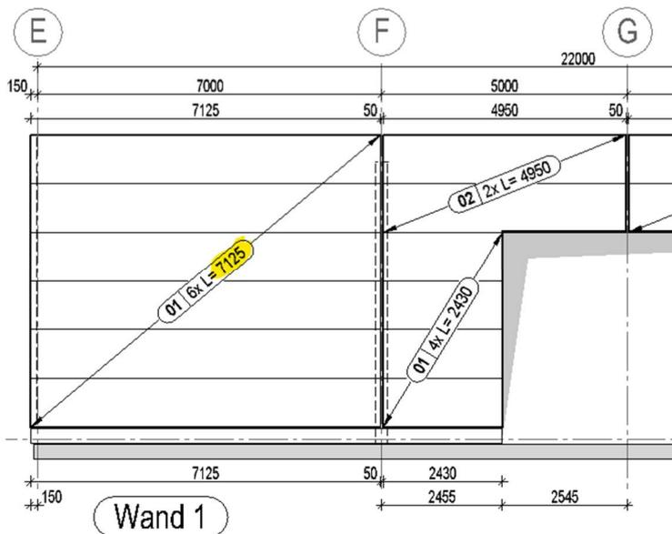
Die Anzahl und Länge der Platten wird aus dem Doppelpfeil zur Andeutung des Pakets ermittelt:
