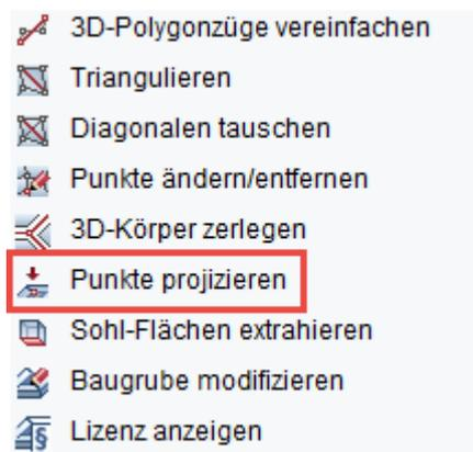
Die neue Funktion projiziert 3D Geländepunkte in Z-Richtung (Höhe) auf eine Baugrube. Somit ist es sehr einfach beliebige Punkte im Gelände mit der Höhe anzuschreiben.
