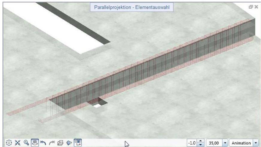
**Hinweis:** Um in der Animation des Bewehrungsplanes die Bewehrung zu sehen, wurde den Betonbauteilen die Oberfläche **Beton\_bewehrt.surf** zugewiesen, die eine Transparenz von 50% besitzt. Alternativ können Sie auch die Transparenz der Oberfläche **Beton.surf** ändern und neu abspeichern. Die Änderung gilt dann aber für alle Betonbauteile im gesamten Projekt.
